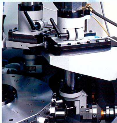
垂直サポート 垂直マシニング・ユニット取り付け用
