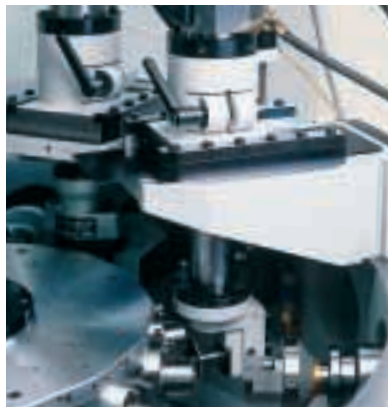
Vertikalsupport für den Aufbau von vertikalen Bearbeitungseinheiten
