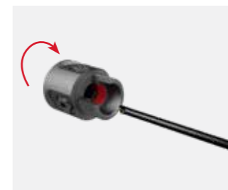
Station 10H, Werkzeug 3, Capto-Halter Innendrehen
