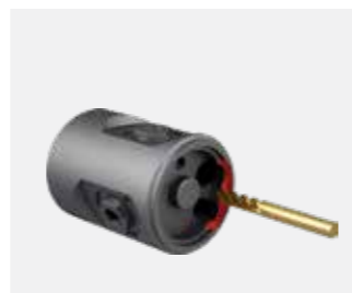
Station 6H, Werkzeug 1, Revolver Aussparung fräsen
