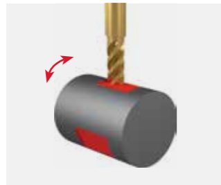
Station 2V, Werkzeug 1, Revolver Flächen fräsen
