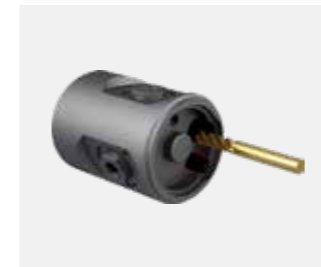
Station 6H, Werkzeug 2, Revolver Kanten brechen / entgraten
