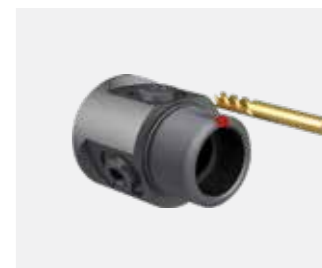
Station 11H, Werkzeug 1, Revolver Nut fräsen
