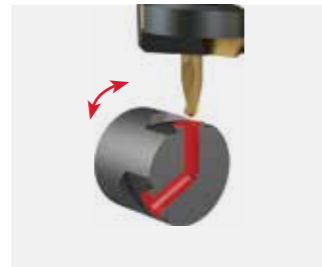
Station 2V, Werkzeug 2, Revolver Querbohren
