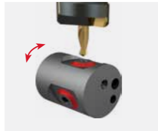
Station 4V, Werkzeug 1, Revolver Nut drehen
