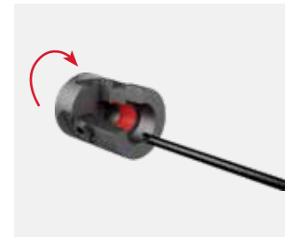
Station 9H, Werkzeug 4, Revolver Innenkontur drehen
